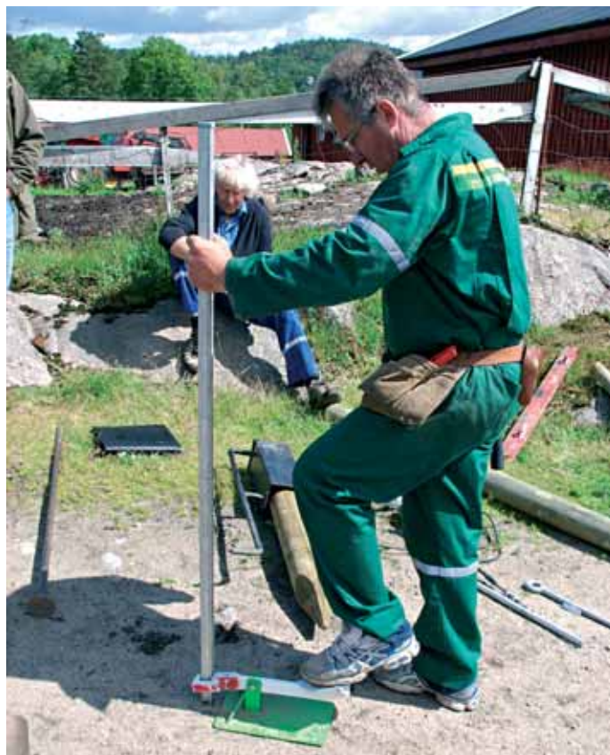
Harald Støyl demonstrerer ein jekk for å ta opp stålstolpar som er slegne ned i jorda.
