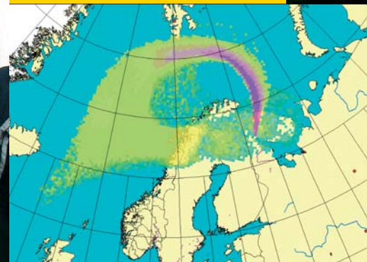
Simulering av radioaktive utslipp fra en av reaktorene på Kola kjernekraftverk i Statens stråleverns beslutningsstøttesystem ARGOS. Illustrasjon: Statens Strålevern.
