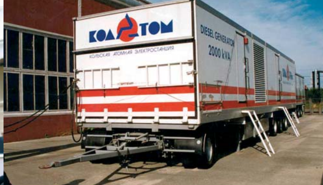
For å sikre strømtilgangen til kjølesystemet ved Kola kjernekraftverk finansierte Norge en mobil diesel-generator. Foto: Statens Strålevern.
