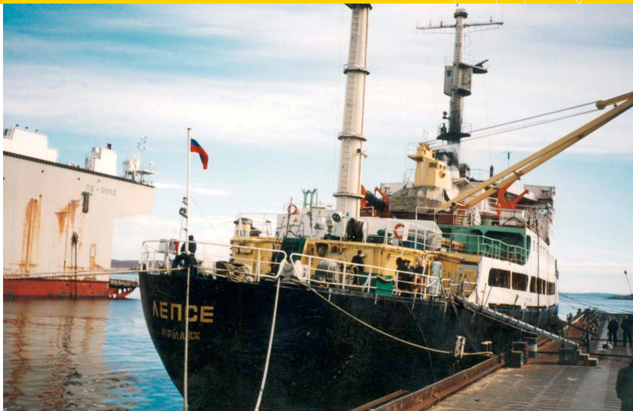
Skipet Lepse, som ligger til kai ved Murmansk, benyttes som lagringsfartøy for brukt kjernebrensel fra atomdrevne isbrytere. Foto: Statens strålevern.
