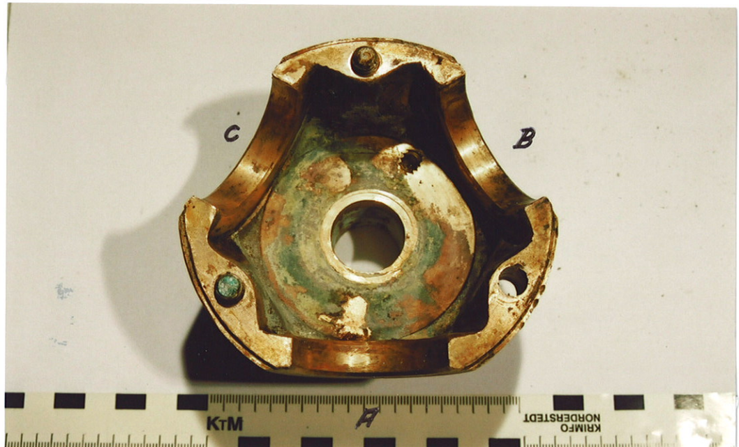
Fig. 11 Bakre (aktre) del av propellhuset etter rengjøring i ultralydbad. Ingen skademerker av betydning ble observert i bossets innvendige overflate. En betydelig ordinær driftslitasje ble imidlertid registrert.
