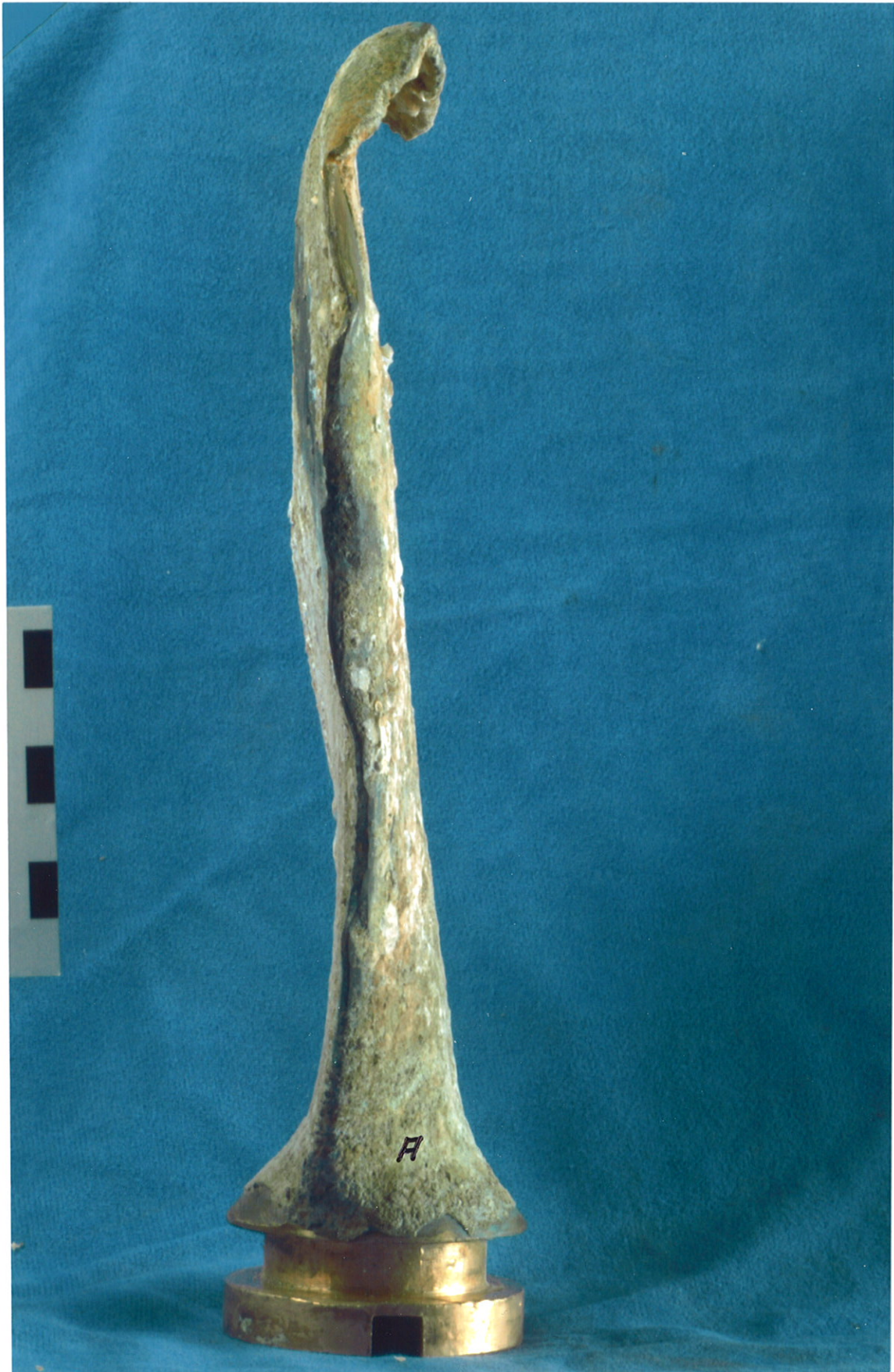
Fig. 18 Illustrasjon av deformasjonsprofil for propellblad A, vist i Fig. 15.
