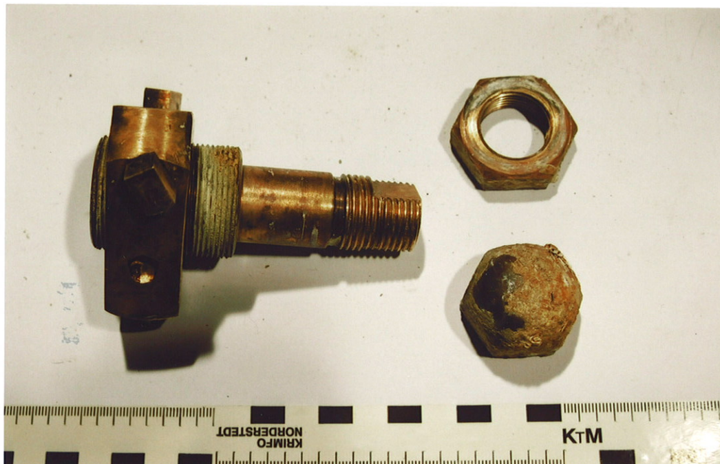
Fig. 13 Detaljbilde av pitchsettingmekanismen for propellbladene. Akselen med det trekantede tappstykket ( og tapper innmontert) er sett fra siden, mens stillmutter og låsemutter (koppmutter) er sett fra akter.
