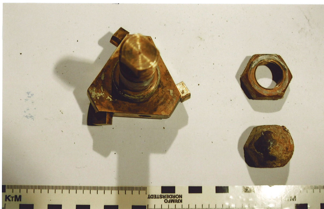
Fig. 14 Detaljbilde av pitchsettingmekanismen for propellbladene, nå vist med det trekantede tappstykket i profil (ref. Fig. 13) Tappene viste ingen deformasjoner, men en betydelig ordinær driftslitasje på tappenes sideflate ble registrert.
