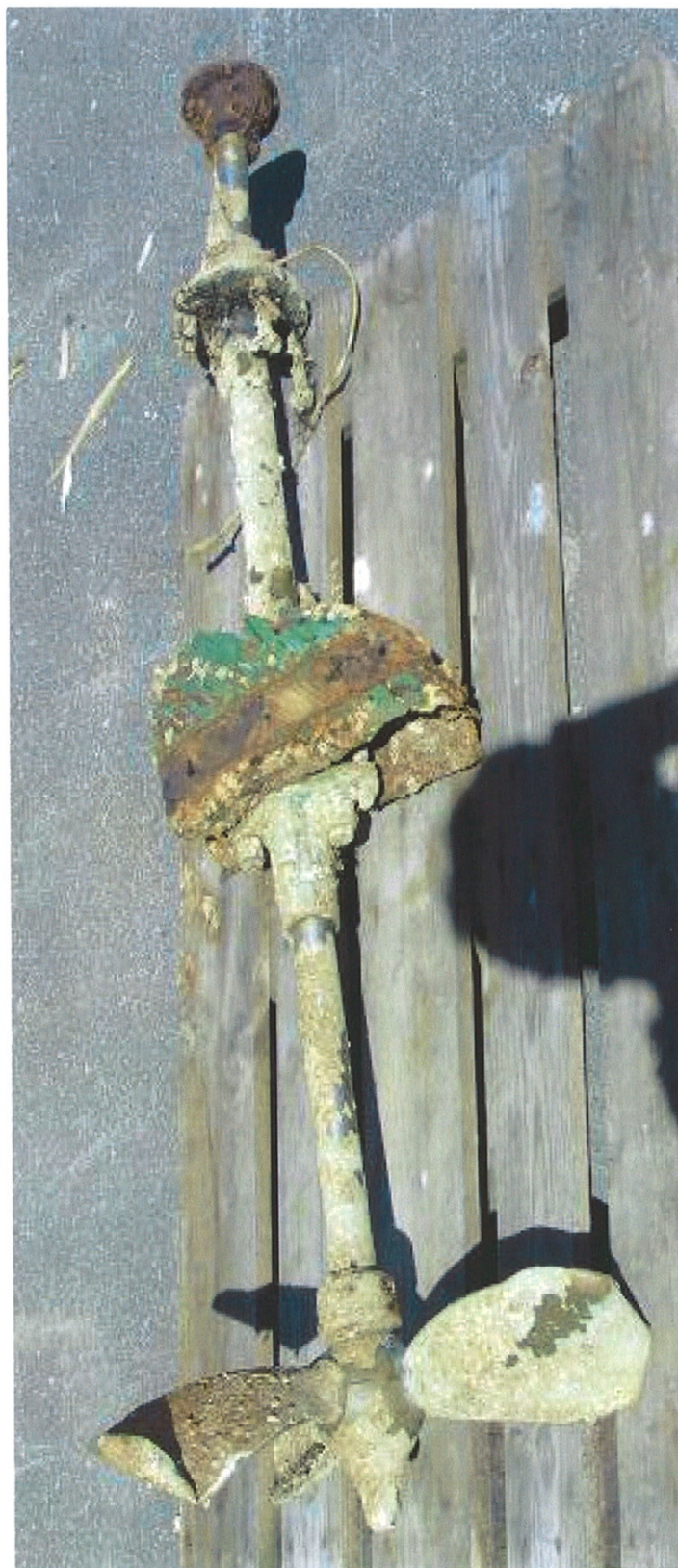
Fig.1 Oversiktsbilde propellakselenhet fra lettbåt til fiskerbåten "WESTERN", bestående av kopplingsflenser, propellaksel, akselhylser og utvendig justerbar 3-bladet propell. (Bilde v/ Undersøkelseskommissjonen etter Westerns forlis.)
