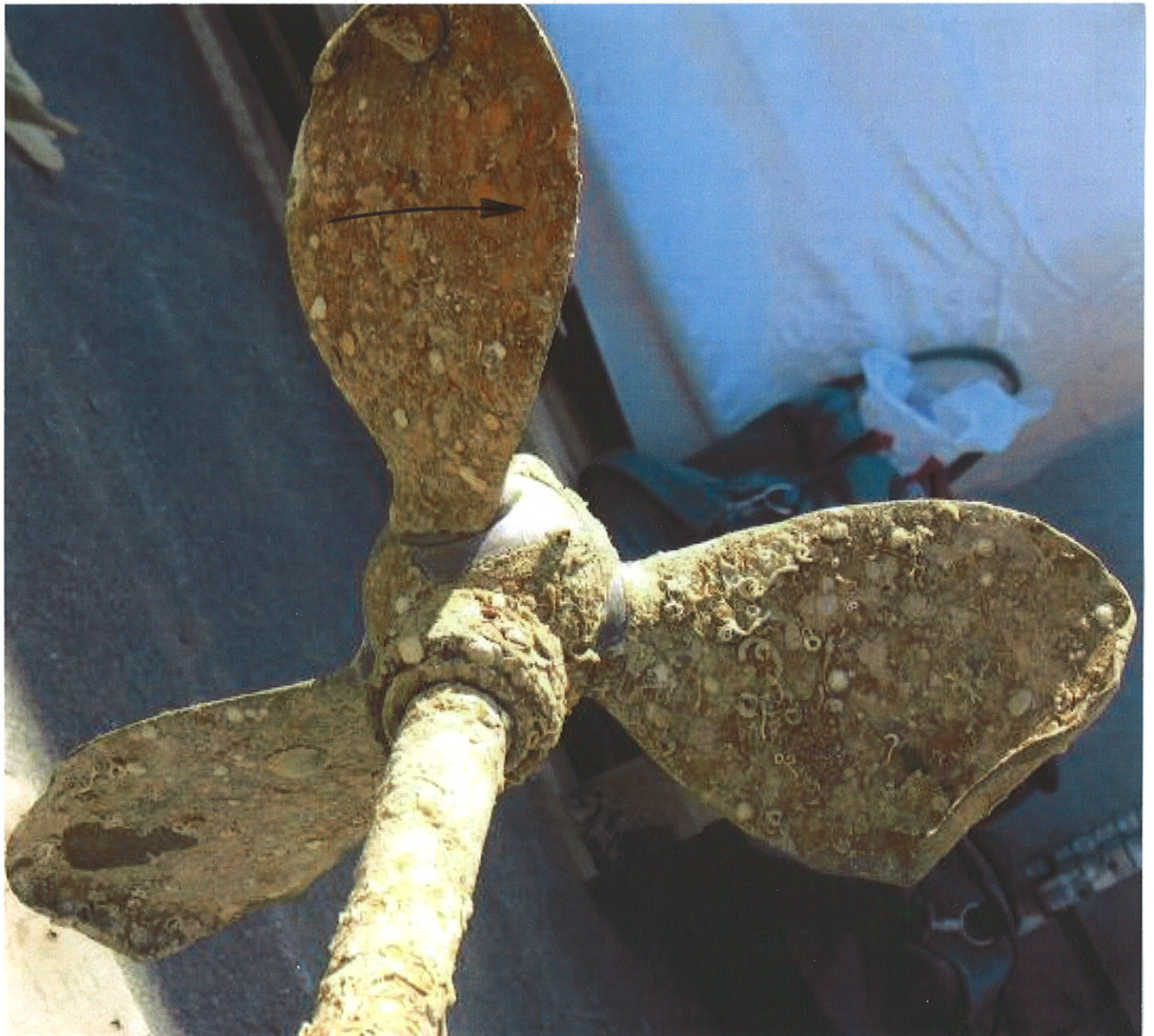
Fig. 2 Nærbilde av lettbåtens justerbare propell slik den fremsto etter heving. I følge opplysning fra Nøgva Motorfabrikk A/S skal propellaksen være venstreroterende sett i fartøyets fartsretning, d.v.s. propellrotasjon som pilmerket på bildet. (Bilde v/ Undersøkelseskommissjonen etter Westerns forlis.)
