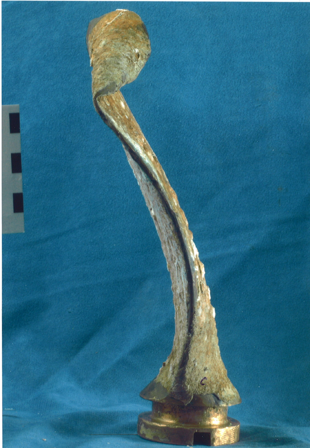
Fig. 20 Illustrasjon av deformasjonsprofil for propellblad C, vist i Fig. 17.
