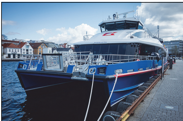
Figur 5.15 Ryger Elektra, Norges første hurtigbåt med helelektrisk drift.
