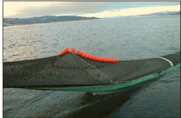
Figur 4.2 Seleksjonsrist i sildetrål.
