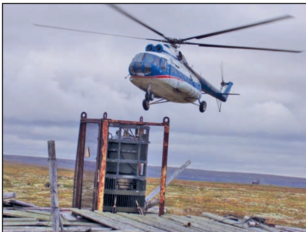
Figur 3.4 På utilgjengelige steder må RTG-ene fraktes ut med helikopter.
