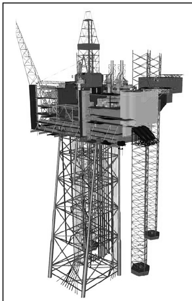
Figur 2.1 Skisse av Edvard Grieg-innretningen med oppjekkbar borerigg
