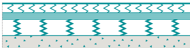
Prinsipiell oppbygging av kombielastisk gulv
