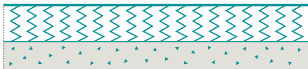
Prinsipiell oppbygging av punktelastisk gulv
