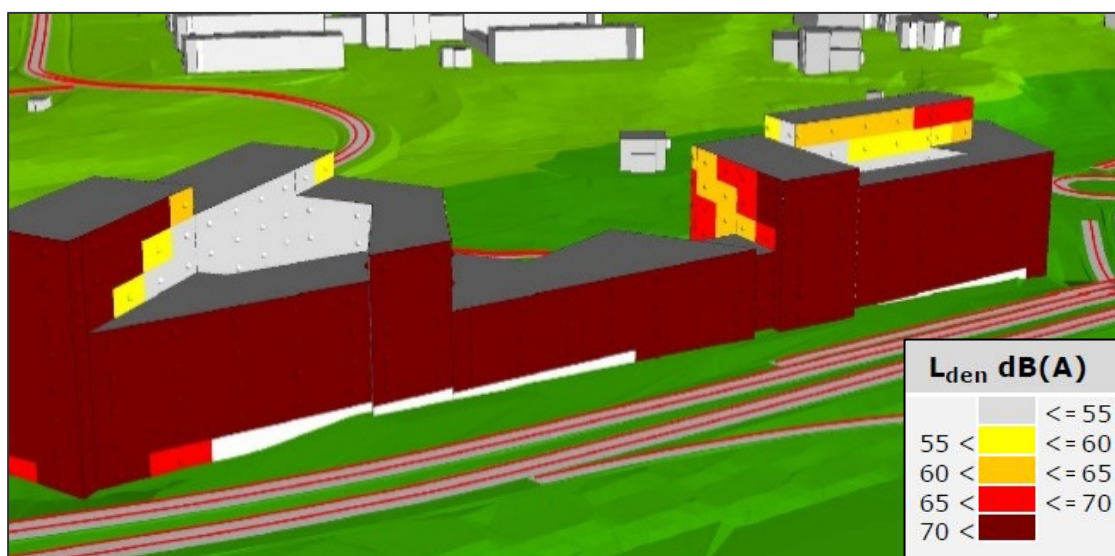
Figur 157: Fasadestøy på V-bygget mot Ring 3
