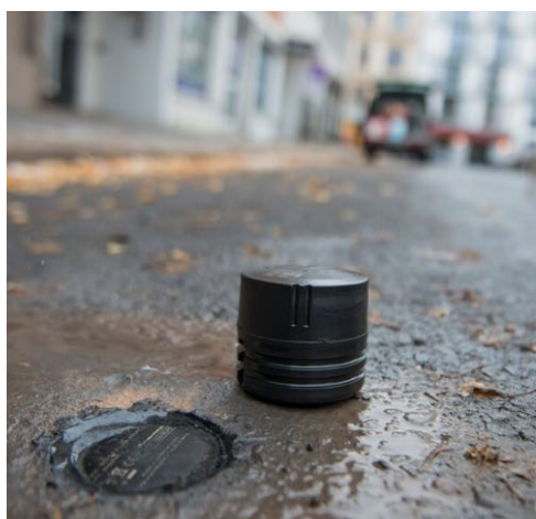
Figur 31: Eksempel: Sensor som registrerer om en bil er parkert ved gateparkering. En sensor drevet av et batteri med lang levetid fresaes ned i bakken og har kommunikasjon med et baksystem. Foto: Mathias Klingenberg.
