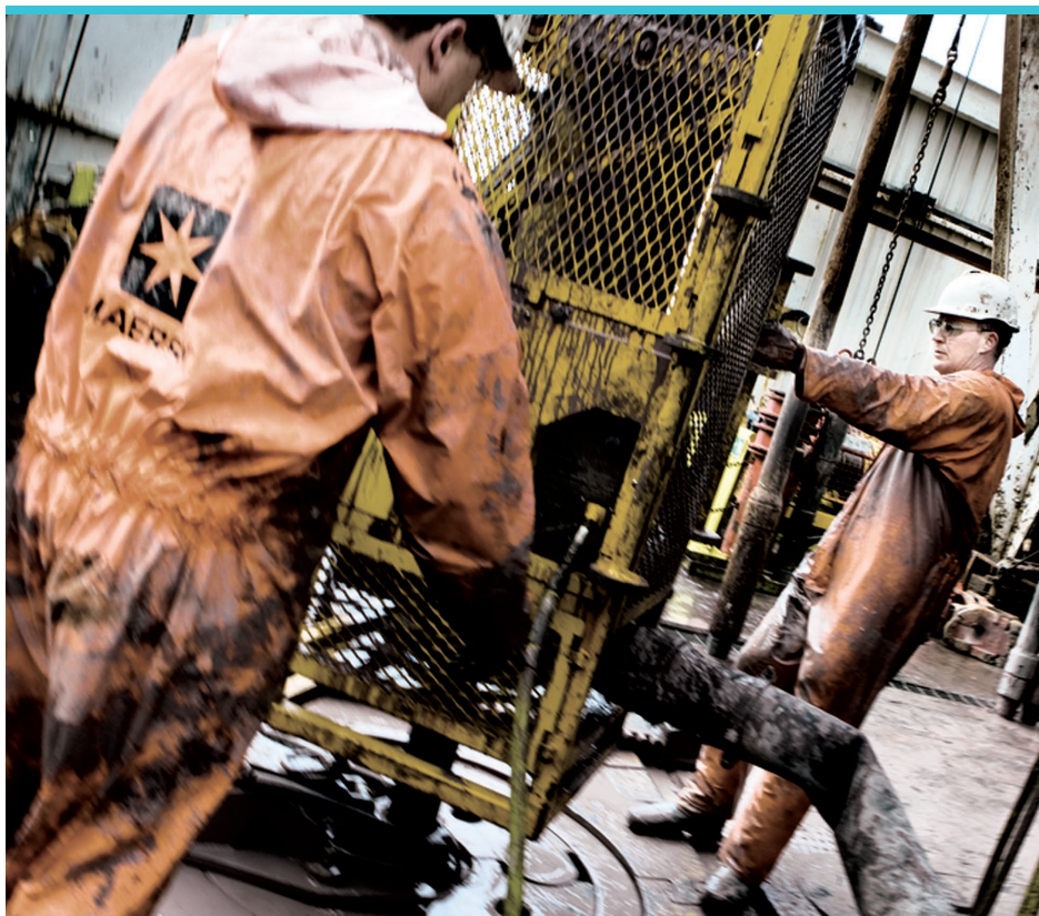
Borerør skrues fra hinanden – eventuel overskuds boremudder ledes til muddertanken via slangen til højre i billedet.
