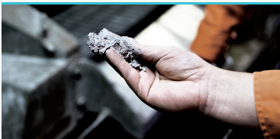
Typisk konsistens af kalk borespåner der udledes efter separation fra vandbaseret boremudder.
