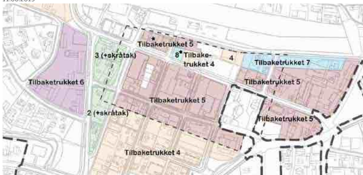
Byggehøyder. Toppetasje i BS_4 A skal tilbaketrekkes 3 m fra torget, og toppetasje i BS_4 B skal tilbaketrekkes 5 m fra torget og Arbeidergata, for minst mulig skyggevirkning på torget. Kilde: Områderegulering Mjøndalen sentrum 11.06.2019
