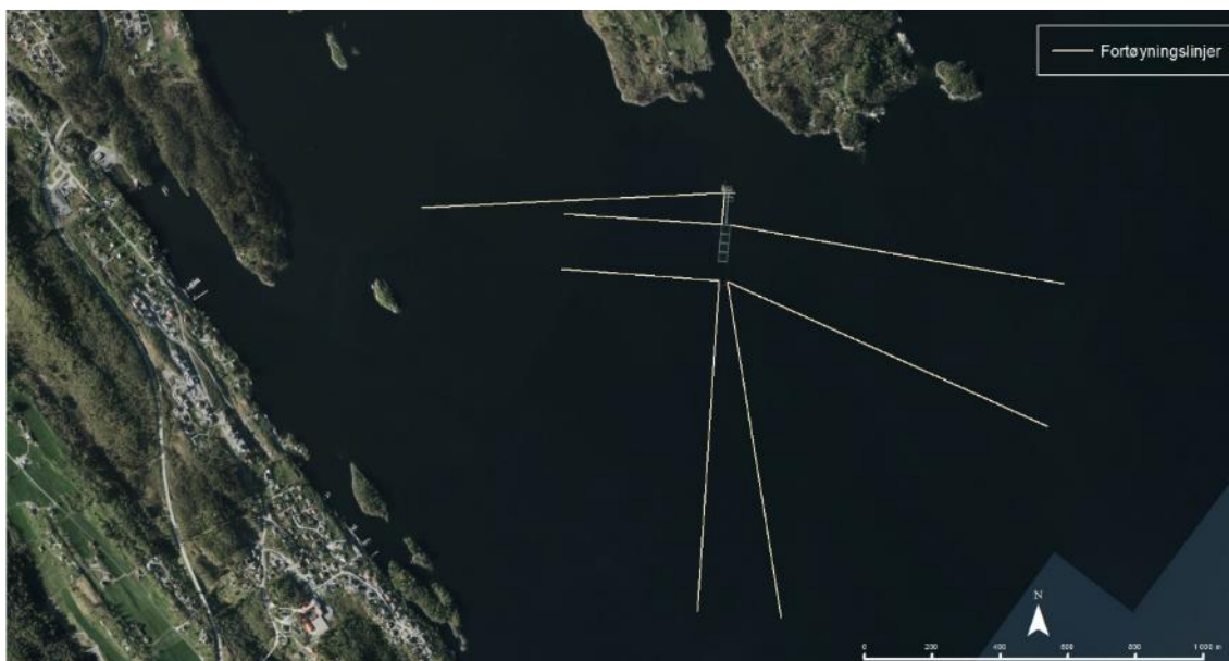
Figur 6.27 Oppdrettsanlegg for laks/ørret, med og uten fortøyninger. (Norge i bilder)
