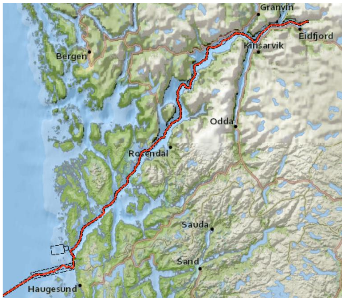
Figur 9-1 Kabeltrasé fra innløpet til Hardangerfjorden til Sima
