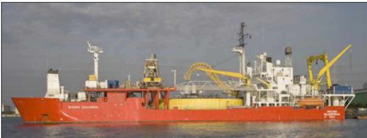
Figur 2.4. Kabelleggingsfartøyet Skagerrak har vært brukt til tilsvarende kabellegginger.
