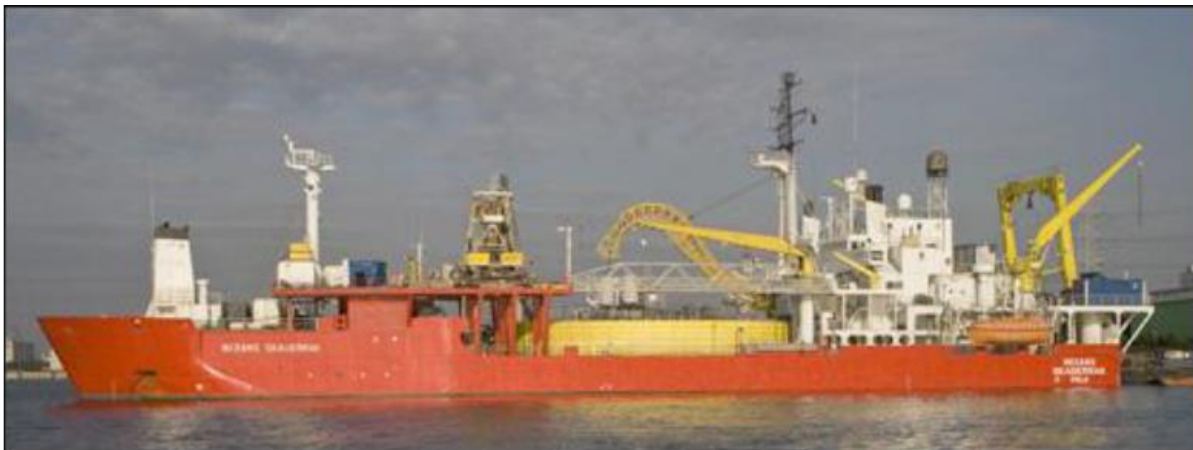
Figur 2.4. Kabelleggingsfartøyet Skagerrak har vært brukt til tilsvarende kabellegginger.
