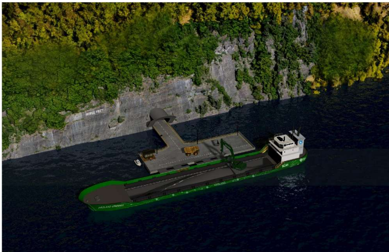
Figur 2 Illustrasjon av planlagt kai ved Kongkleiv. Kaien vil etableres som en flytekai med en landgang inn til tunnellinggangen.
