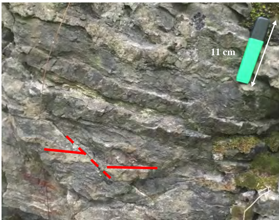
Figur 6: Blotning av Herøyaformasjonen ved siden av BH 08. Lagdelingen vises tydelig, rød linjen indikerer en (normal) forskyvning langs en sprekke i lagdelingen
