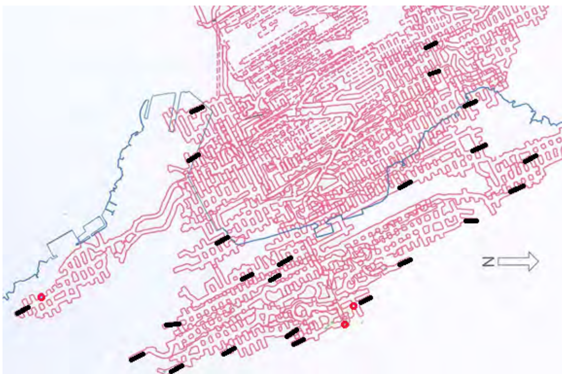
Figur 23 Kart som viser deler av Gruveområdet og lokaliteter hvor bergslag har funnet sted (vist av røde, små ringer). Svarte små streker i stollene viser enkelte av stedene hvor det er foretatt mer omfattende bergbolting.
