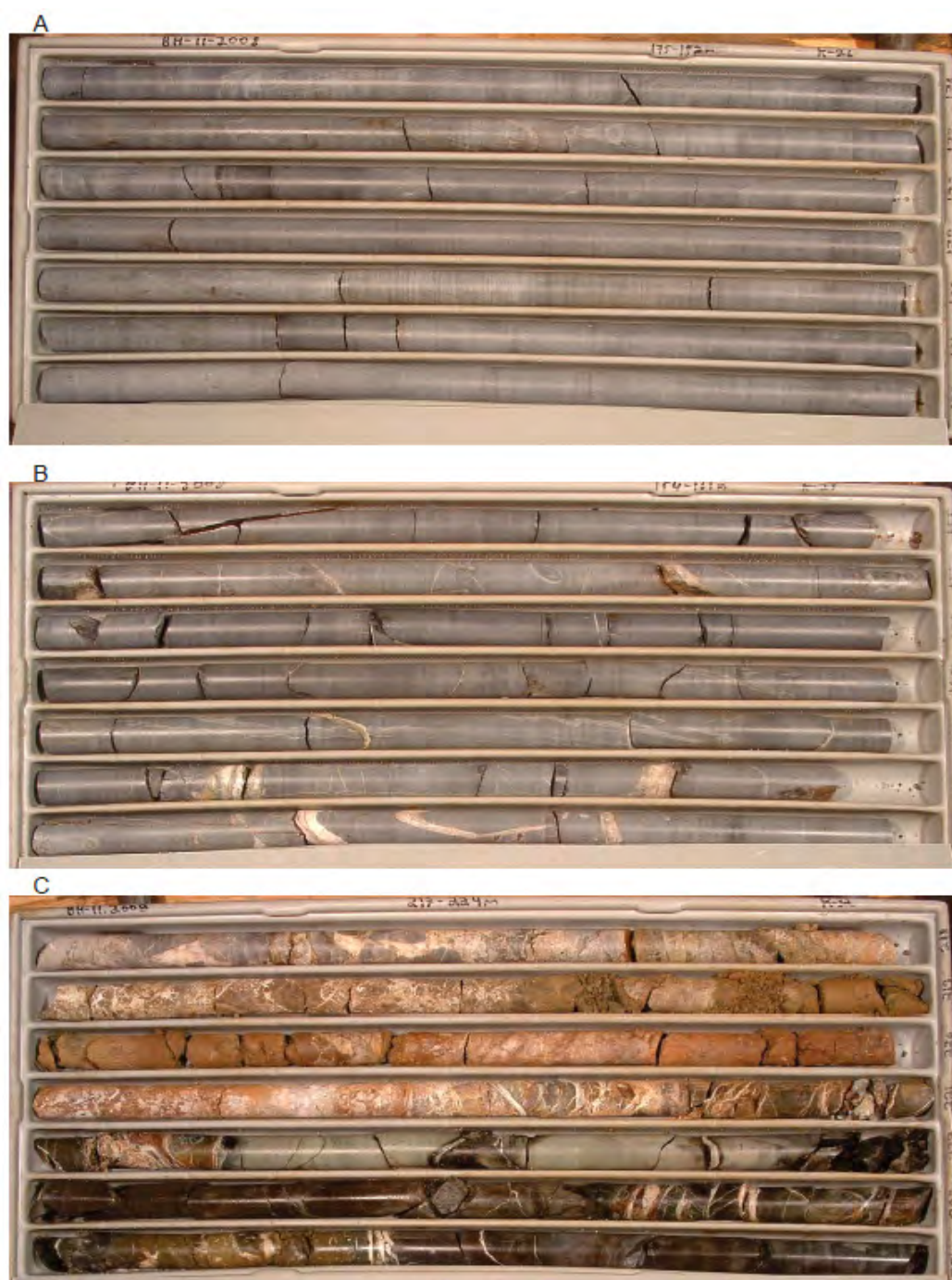
Figur 10 Eksempler på borkjerner fra et 504 m langt borhull påsatt i Dalen gruve under Eidangerfjorden (Nivå -240). Kasse A viser hel og fin typisk Dalen kalksten; mørke sprekker fremkom under kjernebehandlingen etter opptak. Kasse B viser det samme, men gamle sprekker er limt sammen av kalkspatt. I Kasse C går hullet inn i en forkastning; man aner rester av kalkstein øverst til venstre. De neste 4 m er en kalkspattbreksje med rustbrune, jordaktige masser. Hullet går så inn i hornfels fra Fossum fm. i liggen av kalksteinen. Spranghøyden i forkastningen er ca. 40 m og det seg inn vann med saltsmak i borhullet.
