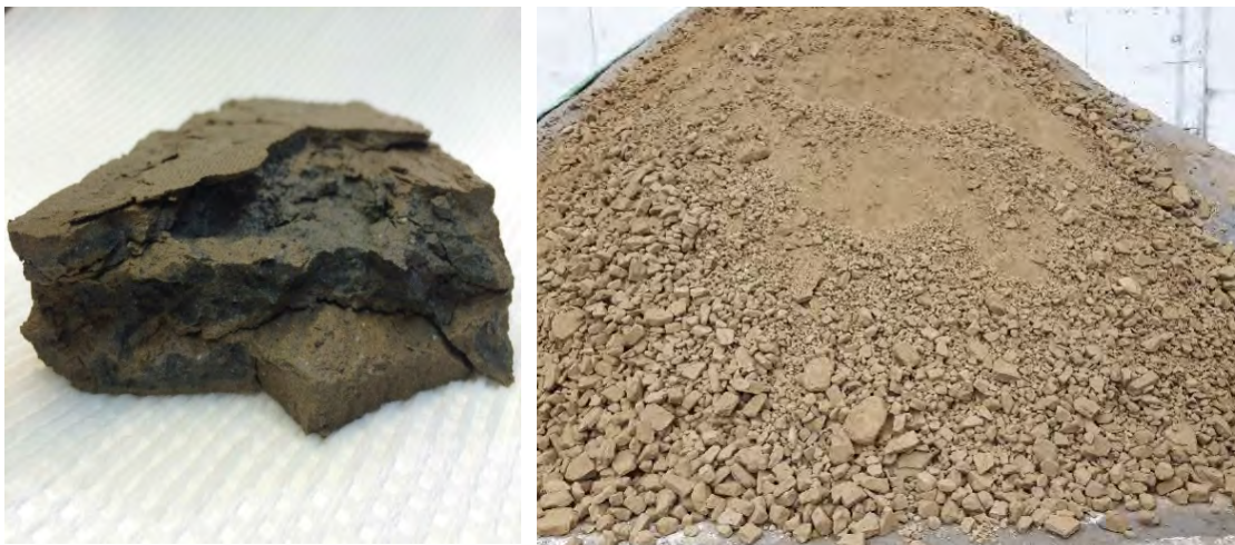
Figur 49 Stabilisert filterkake er tenkt deponert i gruva i Brevik. A) Filterkakebit fra testkjøring i desember 2014. (Foto: NGI) B) Filterkake fra testkjøring i 2018 (Foto: NOAH). Filterpressen som fjerner vannet i det stabiliserte avfallet gir et restprodukt med ca. 65% tørrstoffinnhold.
