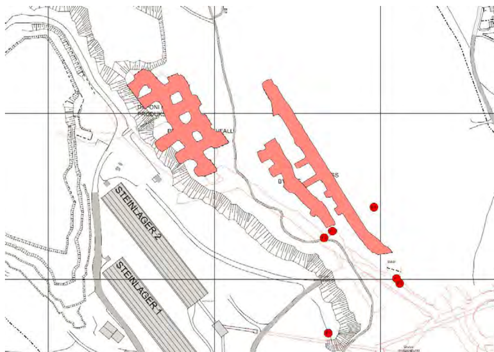
Figur 43 Lokalisering av deponi for produksjonsavfall fra sementproduksjonen i Dalen gruver (markert med lys rød farge). Prøvepunkter for sigevann er vist med røde ringer
