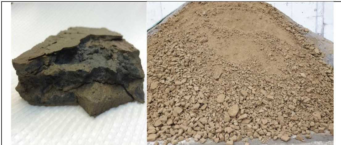
Figur 4-4: Stabilisert filterkake er tenkt deponert i graven i Brevik. A) Filterkakebit fra testkjøring i desember 2014 (Foto: NGI) B) Filterkake fra testkjøring i 2018 (Foto: NOAH).
