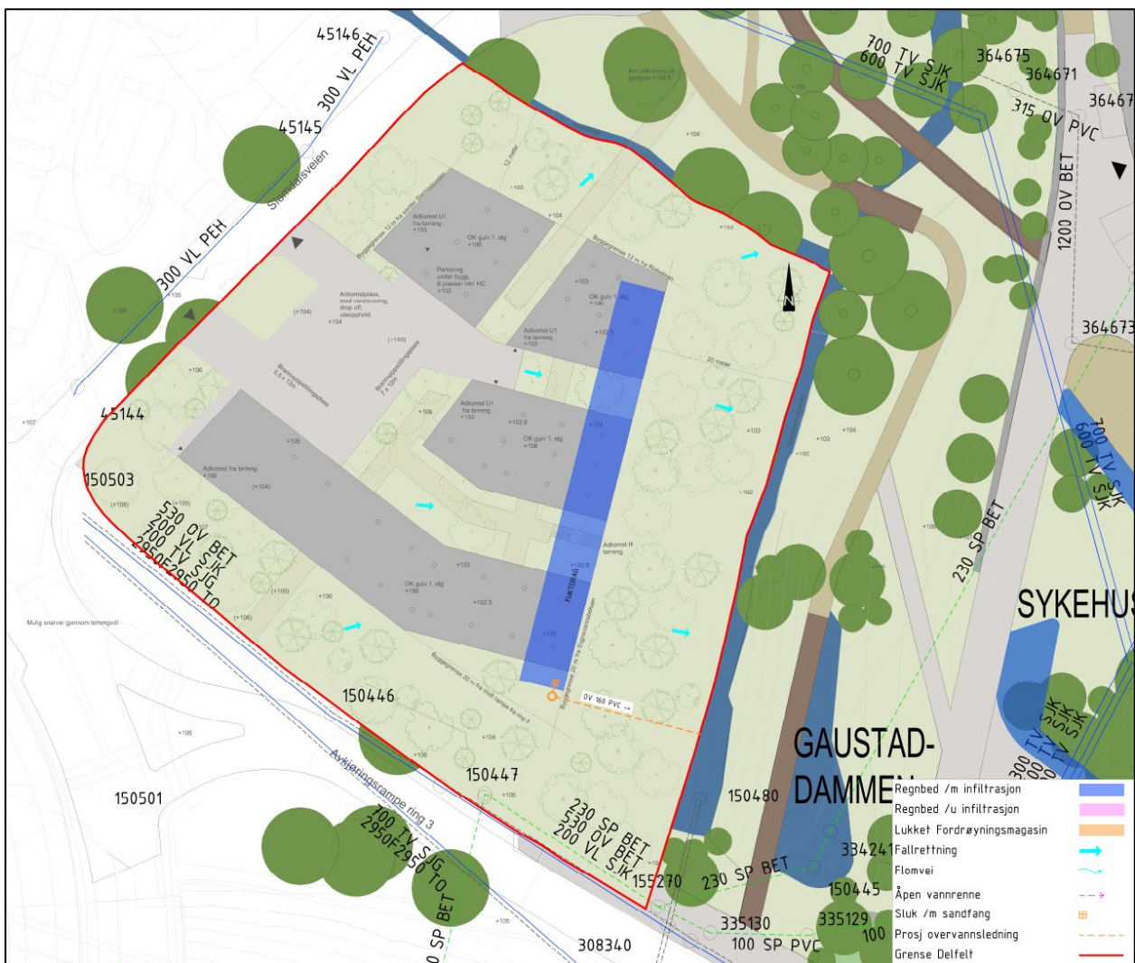
Figur 149: Konsept for overvannshåndtering for delfelt Slemdalsveien
