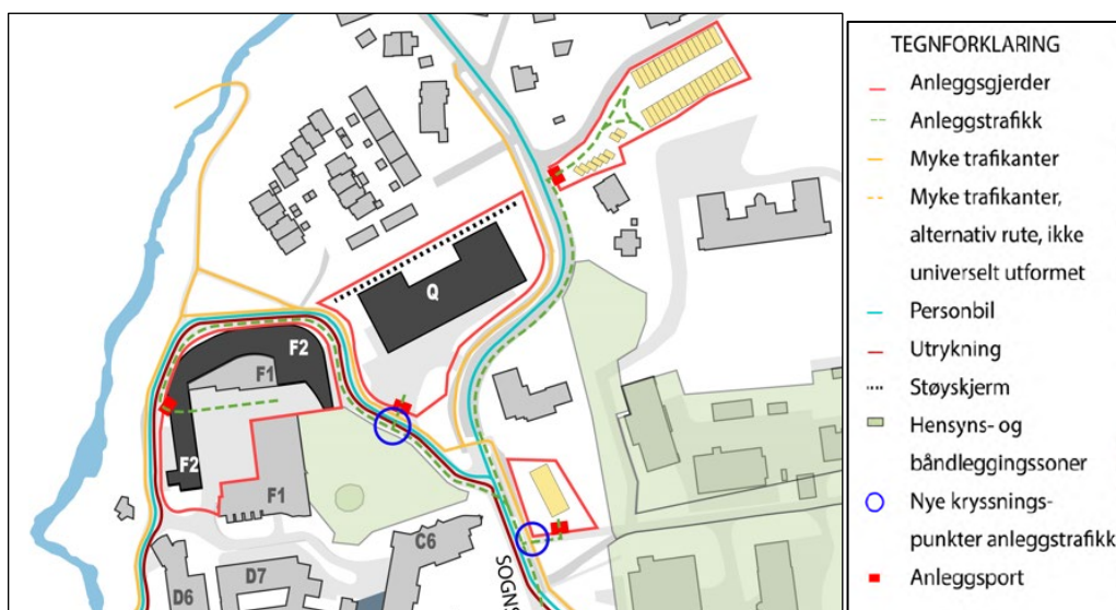
Figur 143: Rigg- og anleggsområde for bygg F2 og Q, med tilhørende anleggsatkomster og -veier.
