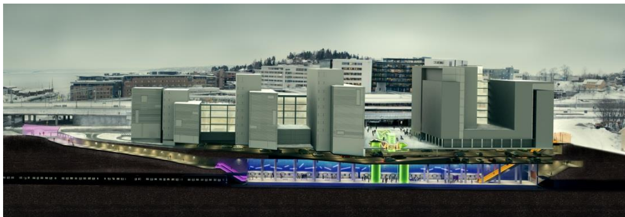
Figur 8-2 Lysaker stasjon med Fornebu-banen i forgrunnen (som i foreliggende reguleringsplan). Hotellbygg på gateplan kommer i konflikt med utvidelse av jernbanestasjonen.
