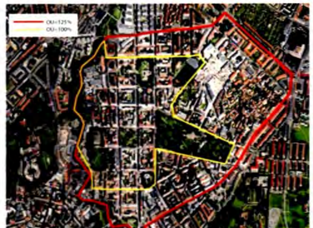
Grünerløkka, Oslo kommune. Eksempel på hvordan avgrensning kan påvirke områdeutnyttelsesgraden. Illustrasjonen er hentet fra Plan- og bygningsetaten.
