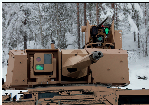
Figur 4.2 Våpenstasjonen Protector kan fjernstyres med høy presisjon fra en lukket vogn, noe som både bidrar til å beskytte operatørene og unngå utilsiktet skade.
