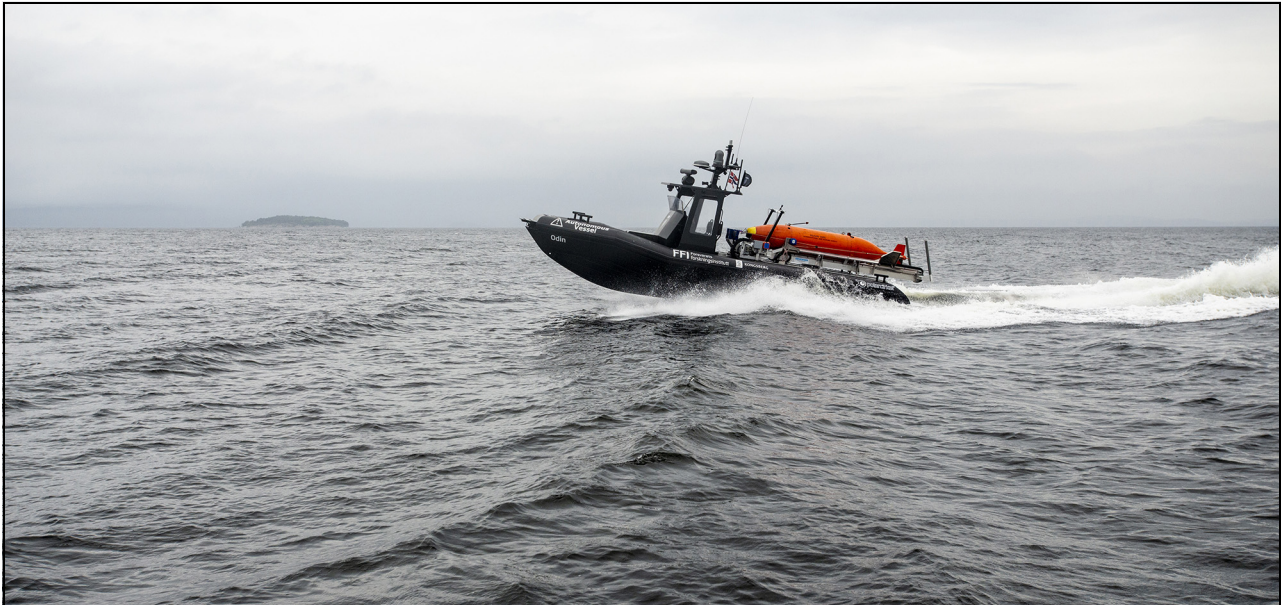
Figur 7.1 I langtidsplanen for forsvarssektoren er det lagt opp til et nytt, ubemannet system for rydding av sjøminer. FFI har lenge samarbeidet med forsvarsindustrien om å utvikle relevant autonom teknologi. Den selvstyrte undervannsfarkosten Hugin er allerede en internasjonal suksess. Den autonome båten Odin er utstyrt med sensorer som gjør den i stand til å oppdage og unngå hindringer. Dette er teknologi som har stort potensial både sivilt og militært.
