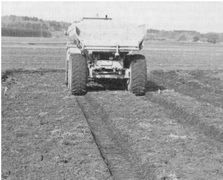
Figur 10. Kjøring med dumper på utlagte løsmasser gir dype hjulspor og pakkingsvirkning dypt nedover i jorda.
