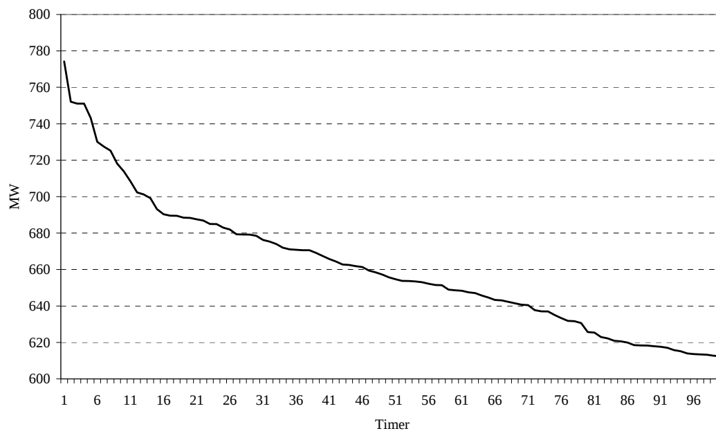
Figur 4-3 Kraftflyt i BKK-snittet fratrullet ledig produksjonskapasitet i BKK-området vinteren 2009/2010, sortert etter avtagende differanse. Kilde: Egne beregninger basert på data fra Statnett og BKK Produksjon*
