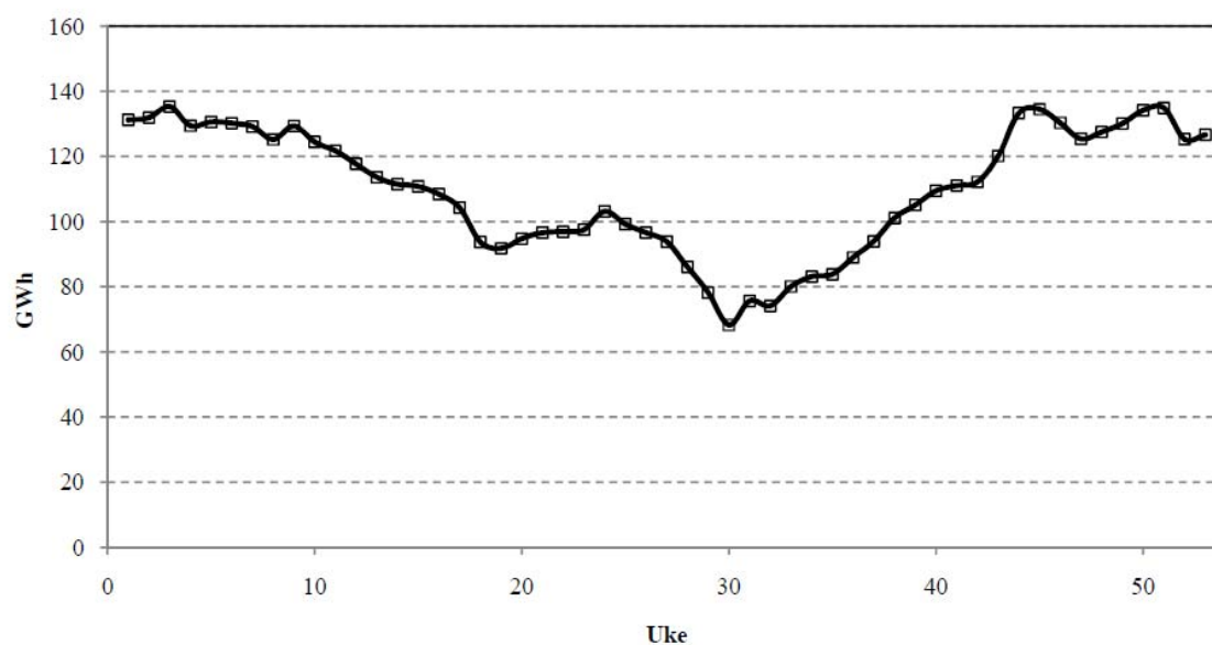
Figur 5-8 Gjennomsnittlig kraftproduksjon per uke i BKK-området. Gjennomsnittet gjelder i perioden 2000 til 2009. Kilde: BKK Produksjon, Statkraft, Statnett og BKK Nett
