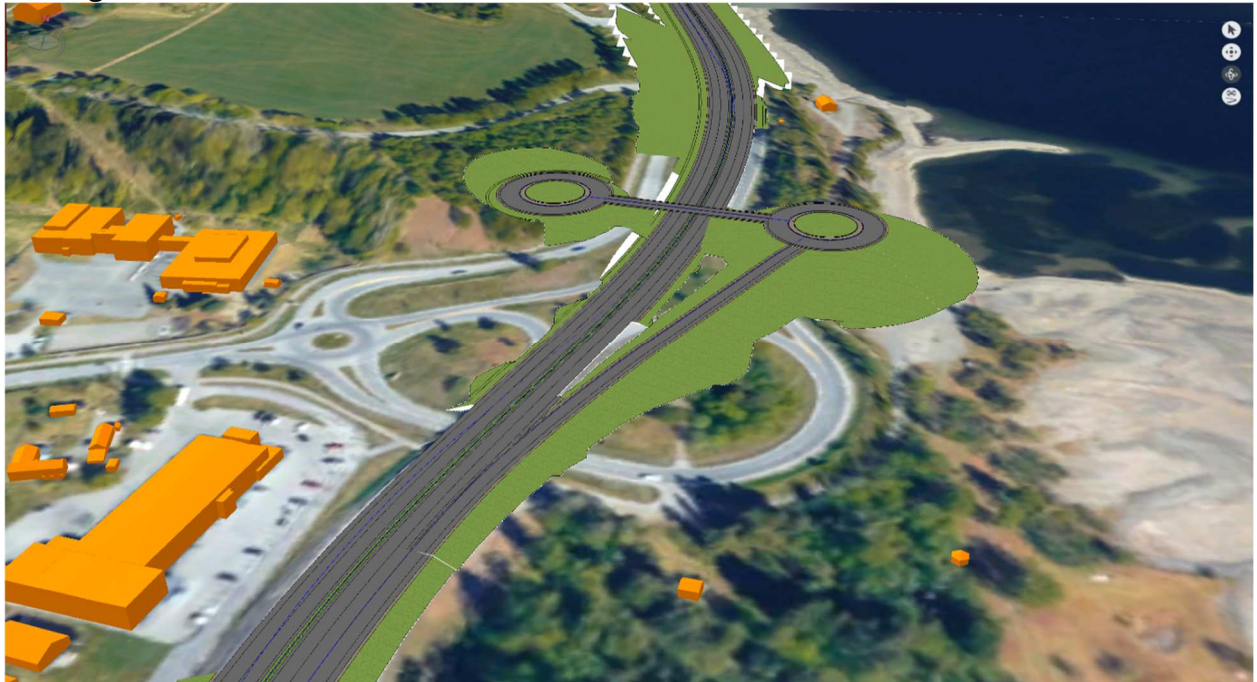
Figur 18 viser et ruterkryss forøkt plassert på eksisterende trafikkareal, kilde; Sweco
