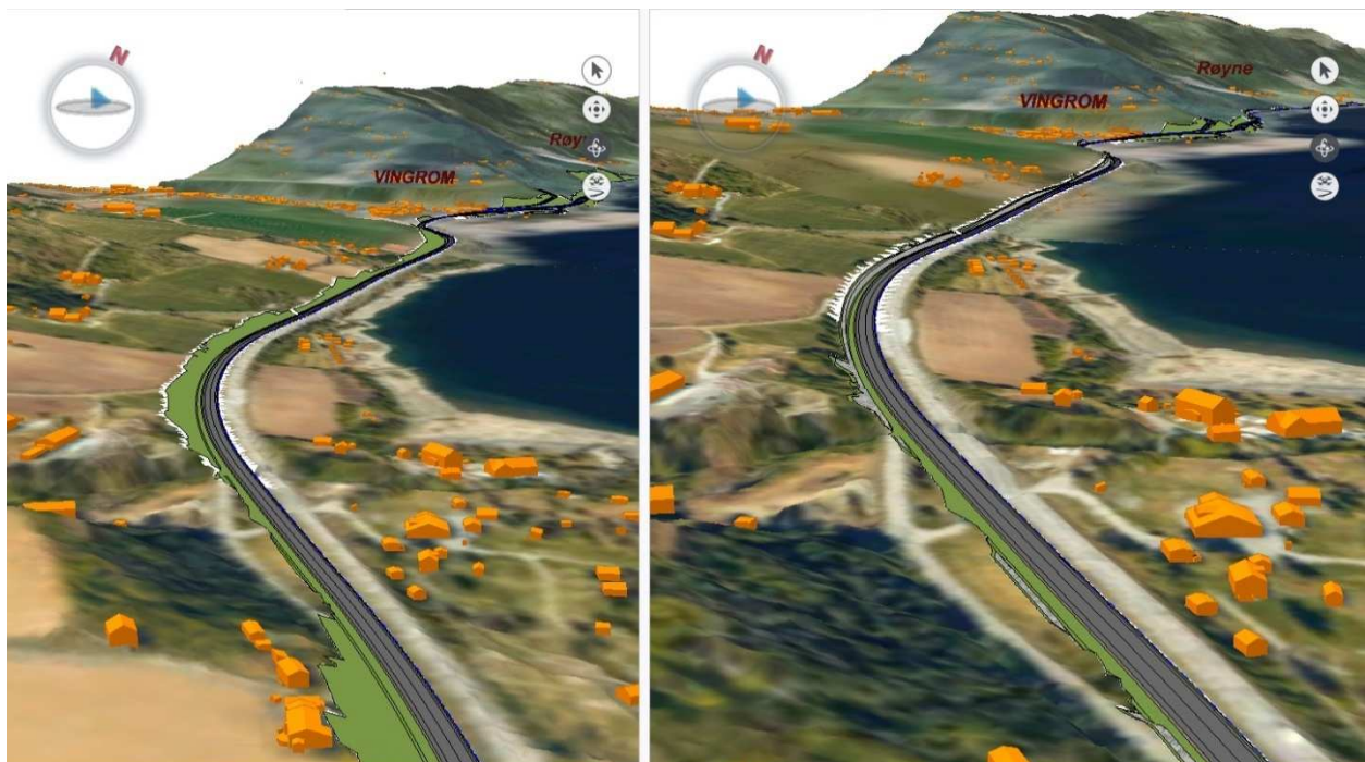
Figur 12 viser nye felt fra Stranda mot Vingrom lagt på vestsiden av eksisterende E6 (uten og med innlagt bergmodell), kilde; Sweco
