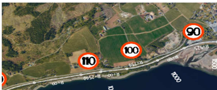
Figur 4 viser eksisterende kurvatur inn mot Vingrom, sett opp mot hvilken hastighet kurvaturen tilfredsstillende, kilde; Sweco
