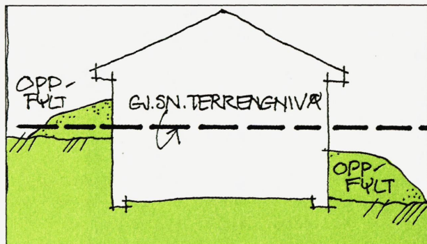
Figur 81 - «Planert» kan bety tilbakefylt, terrassert, oppfylt eller utgravid terreng. Det ferdige terrenget er utgangspunktet for å fastsette gjennomsnittlig terrengnivå rundt bygningen. Høydene rundt hele bygningen er grunnlaget for fastsette et horisontalt nivå. Figurene viser hvordan gjennomsnittlig terrengnivå rundt bygningen kan heves med oppfylling.
