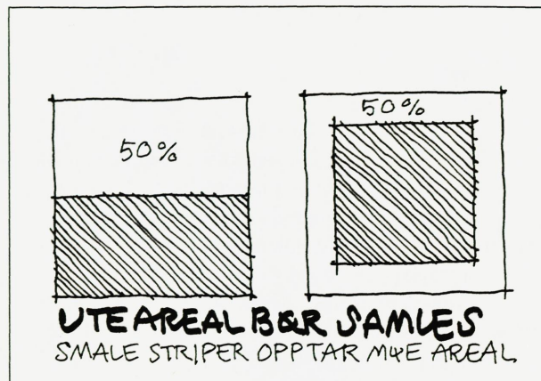
Figur 32 - Eksempel på arealfordeling - Når utearealet samles, virker det større enn når det samme antall kvadrater fordeles i smale striper.
