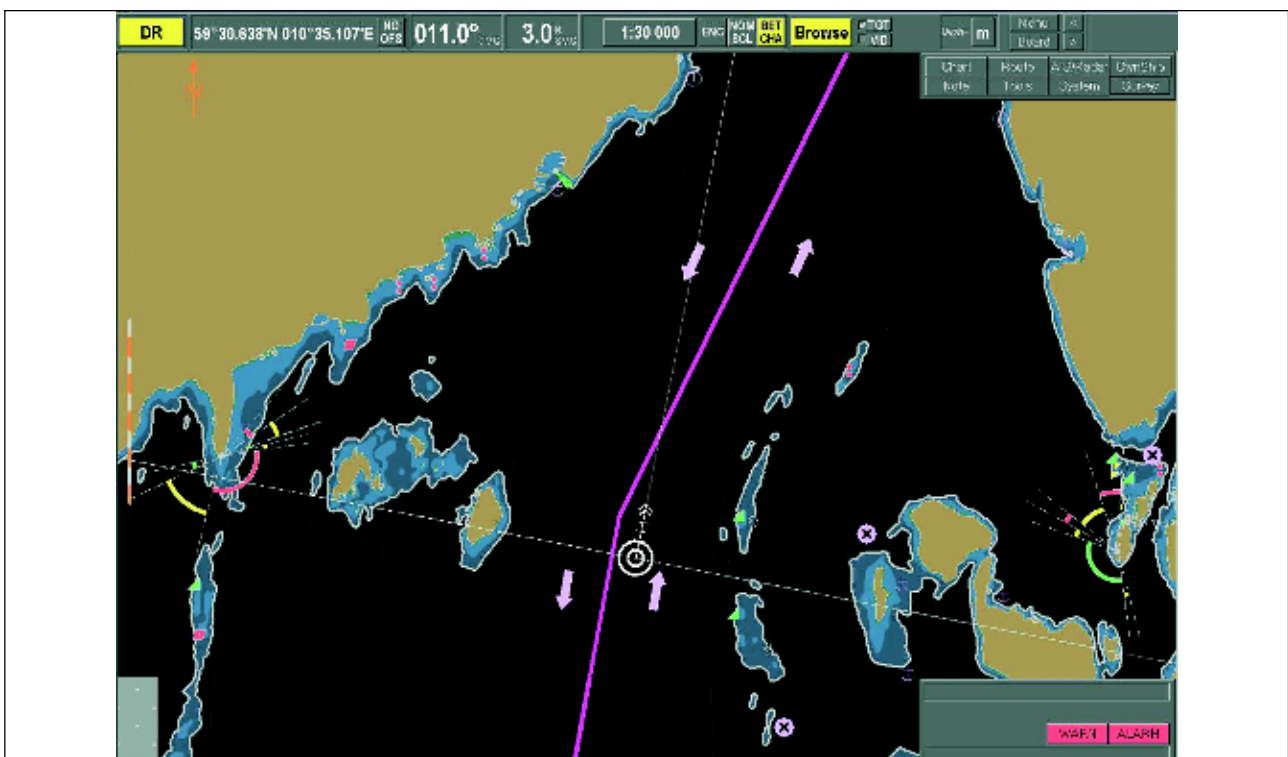
Figur 5.6 Bildet viser det samme området som i figur 8–5, men nå i et vektorbasert ENC-kart. Her kan kartinformasjon, ned til et låst minimumsnivå, fjernes eller legges til etter behov. Det låste minimumsnivået skal hindre at nødvendig informasjon for sikker navigering kan bli fjernet.
