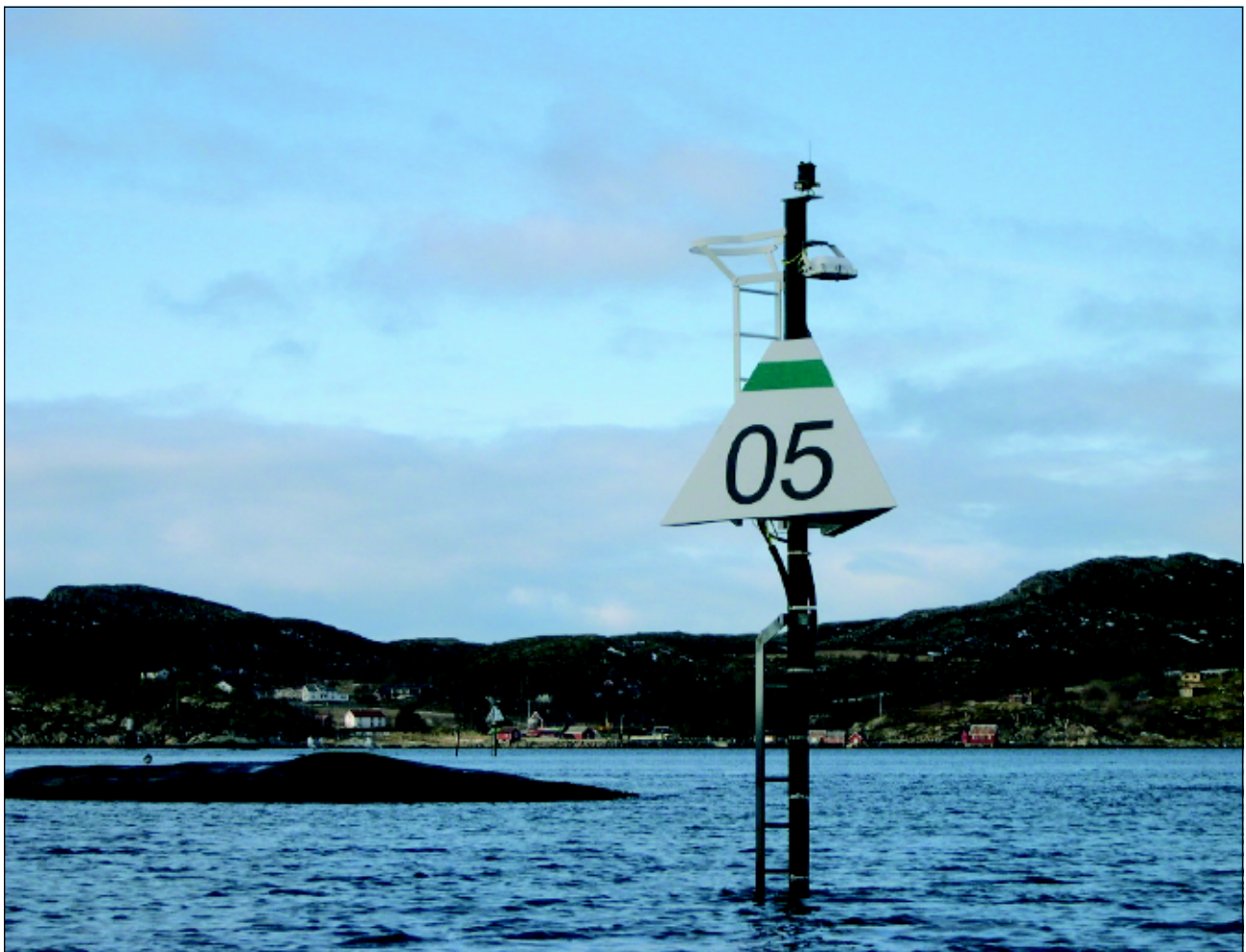
Figur 5.1 Hurtigbåtmerke. Figuren viser en av de ca. 300 lanterne med indirekte belysning, såkalte hurtigbåtmerker (HIB) som har blitt utplassert de siste årene.
